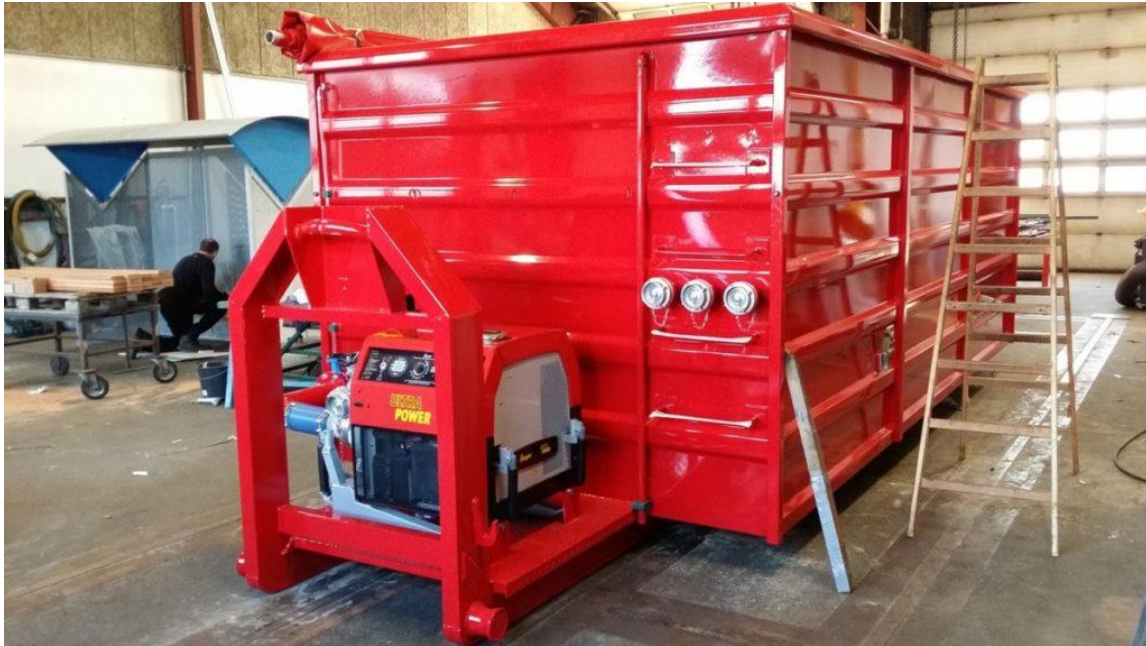
Figur 4 Exempel från Danmark. Container med pump för att kunna förflytta större mängder vatten till brandplats
